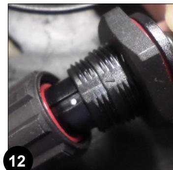
17. Brancher le connecteur du câble d'alimentation de l'écran de commande sur le connecteur du support du réservoir.
