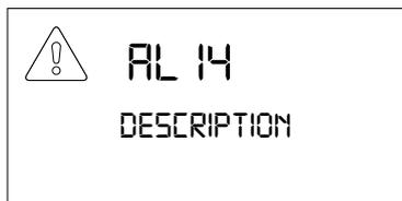
Lorsqu'une erreur se produit, l'écran de contrôle affiche la page d'alarme correspondante, qui restera visible jusqu'à la résolution de l'erreur. La page fournit :
