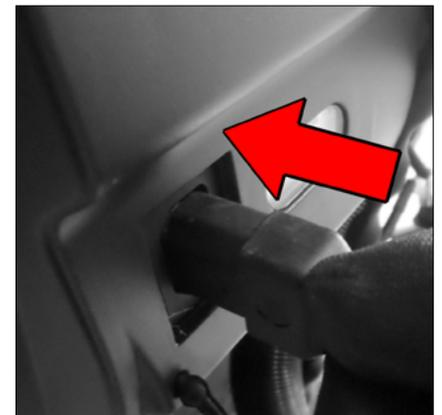
**⚠ AVERTISSEMENT** : avant de mettre le câble d'alimentation du chargeur de batterie dans la prise, vérifier l'absence de condensation ou d'autres types de liquides.
